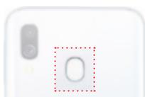
Der Fingerabdrucksensor kann sich auf der Vorder- oder Rückseite des Smartphones befinden oder ist in die Home-Taste bzw. in den Bildschirm eingebaut. Um den Fingerabdrucksensor zu nutzen, muss zuvor der eigene Fingerabdruck bei der Einrichtung des Smartphones gespeichert werden (*weitere Infos in Teil 3 Sicherheit*).
